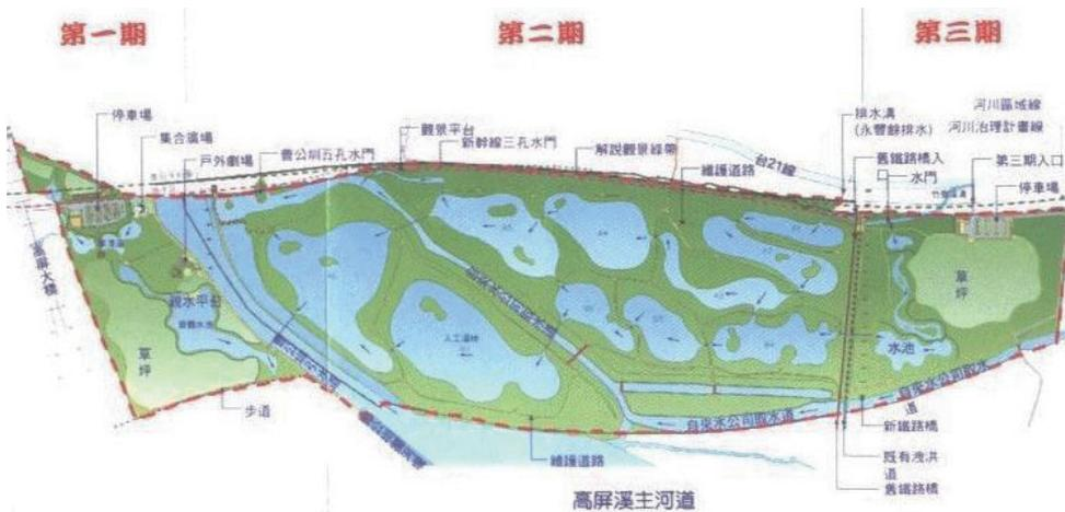
圖2-10：高屏溪右岸人工濕地配置圖
